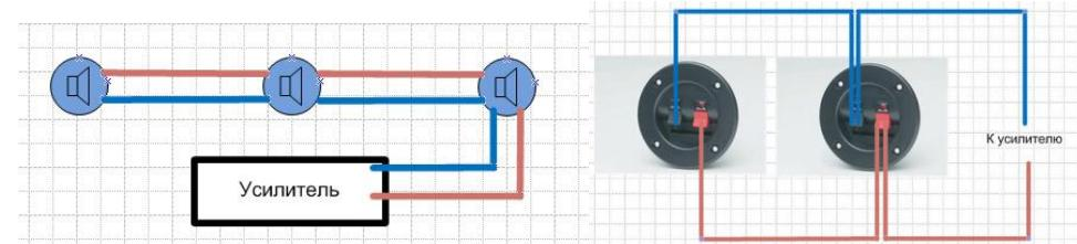
Если громкоговоритель не замыкающий (конечный) в системе, то подключаем к нему входящий и выходящий провод (предварительно соединив его по цветам **синий с синим, красный с красным**). На задней панели усилителя имеются либо клеммы, либо зажимы для выхода на громкоговорители. Необходимо использовать значения COM (или "0") и 100В. К контакту COM мы подключаем **синий** провод, что идет от громкоговорителей, к контакту со значением 100В - **красный**.
